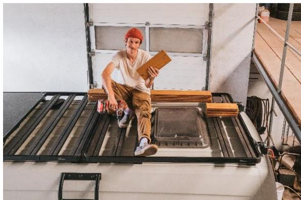
Zum Schluss muss das Holz nun am Dachträger befestigt werden. Wir haben die Terrassendielen mit den Schrauben und Muttern erst leicht befestigt. Bevor alles final festgezogen wurde, haben wir nochmal alle Spaltmaße geprüft und angepasst. Anschließend haben wir alle Schrauben handwarm festgezogen. Bei unserem Dachträger konnten wir die Muttern in die Zwischenspalten der einzelnen Streben einführen und die
